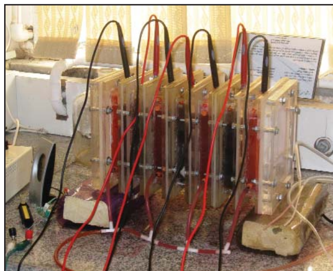
شکل (۲) استک پیل سوختی بیولوژیکی ساخته شده
