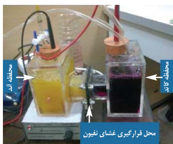
شکل (۱) تک سل پیل سوختی بیولوژیکی میکروبی
